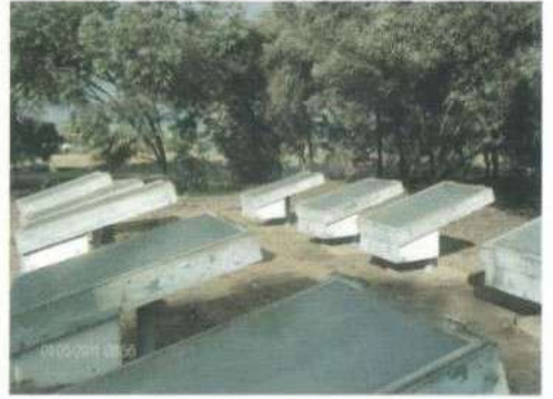
Resim 7: Güneş Enerjisiyle Balmumu eritme paneli
