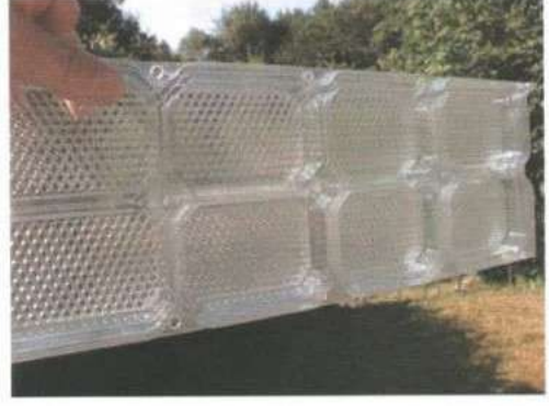
Resim-9: Birbirini tamamlayan yarım çerçeveler birbirine uyacak şekildedir ve düz burun kısımlarının olduğu yerlerde birbirine yapıştırılır.
